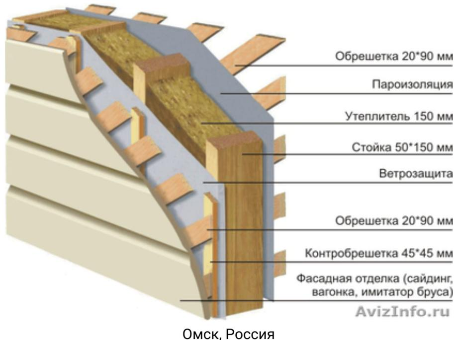
В наши дни деревянно-каркасное домостроение одно из самых популярных и широко применяемое в загородном домостроении. Суть технологии заключается в использовании деревянного каркаса в сочетании с продольным брусом и угловыми элементами придающими прочность и жесткость конструкции. Внутри каркас дома заполняется утеплителем – базальтовой ватой и защищен паро- и ветрозащитными пленками.
